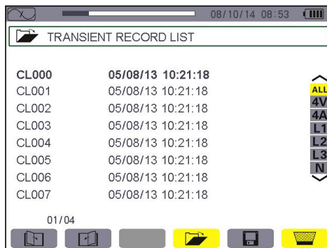
图 6-6 删除暂态测量记录
