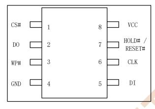
Figure 3.1 SOP8 (150/208mil)/ DIP8 (300mil)
