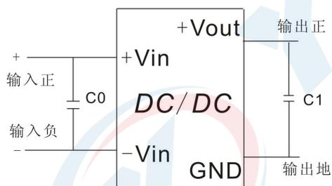
② 输入反射纹波电流测试电路:
