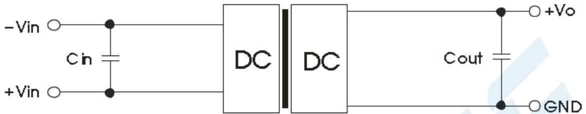
注 1:  $C_{in}$  为  $4.7\mu\text{F}/50\text{V}$ ,  $C_{out}$  为  $10\mu\text{F}/50\text{V}$
