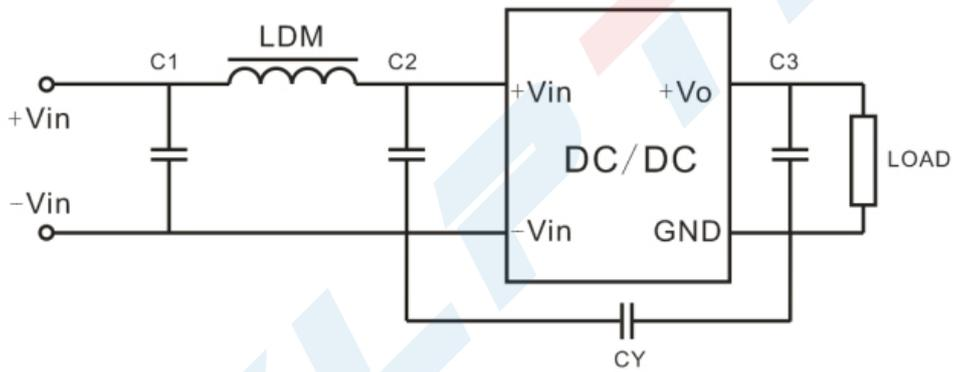
注 2:  $C1$ 、 $C2$  为  $4.7\mu\text{F}/50\text{V}$ ,  $LDM$  为  $6.8\mu\text{H}$ ,  $CY$  为  $1\text{nF}/250\text{Vac}$ ,  $C3$  参考典型电路即可
