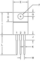
LEAD CODE: 1) Base 2) Collector 3) Emitter Tab) Collector
