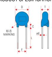
本体颜色: 蓝色 BODY COLOR: SKY-BLUE 包封层: 环氧树脂 COATING: EPOXY RESIN 导线: 镀锡铜包钢线
