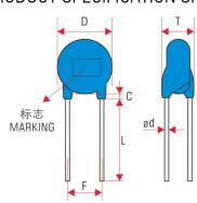
本体颜色: 蓝色 BODY COLOR: SKY-BLUE 包封层: 环氧树脂 COATING: EPOXY RESIN 导线: 镀锡铜包钢线
