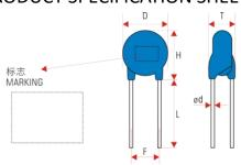
本体颜色: 蓝色 BODY COLOR: SKY-BLUE 包封层: 环氧树脂 COATING: EPOXY RESIN 导线: 镀锡铜包钢线 LEAD WIRE: TIN-COATED COPPER-CLAD STEEL WIRE
