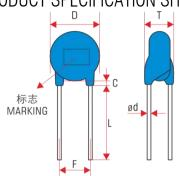
本体颜色: 蓝色 BODY COLOR: SKY-BLUE 包封层: 环氧树脂 COATING: EPOXY RESIN 导线: 镀锡铜包钢线
