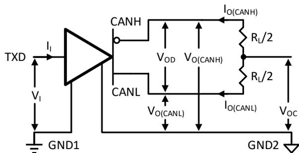
图 8-1 驱动器电压、电流指标定义
