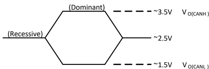
图 8-2 总线逻辑状态的电压定义
