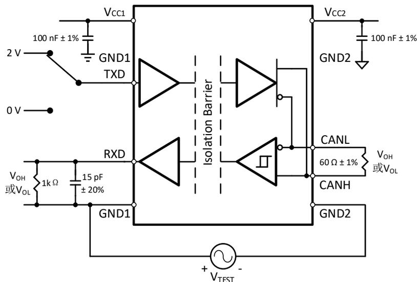
图 8-11 共模瞬态抑制(CMTI)测量电路
