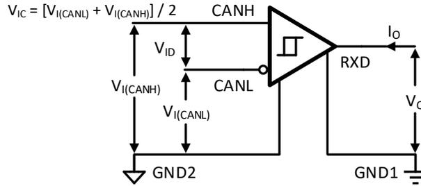
图 8-5 接收器输出电压、电流测试条件
