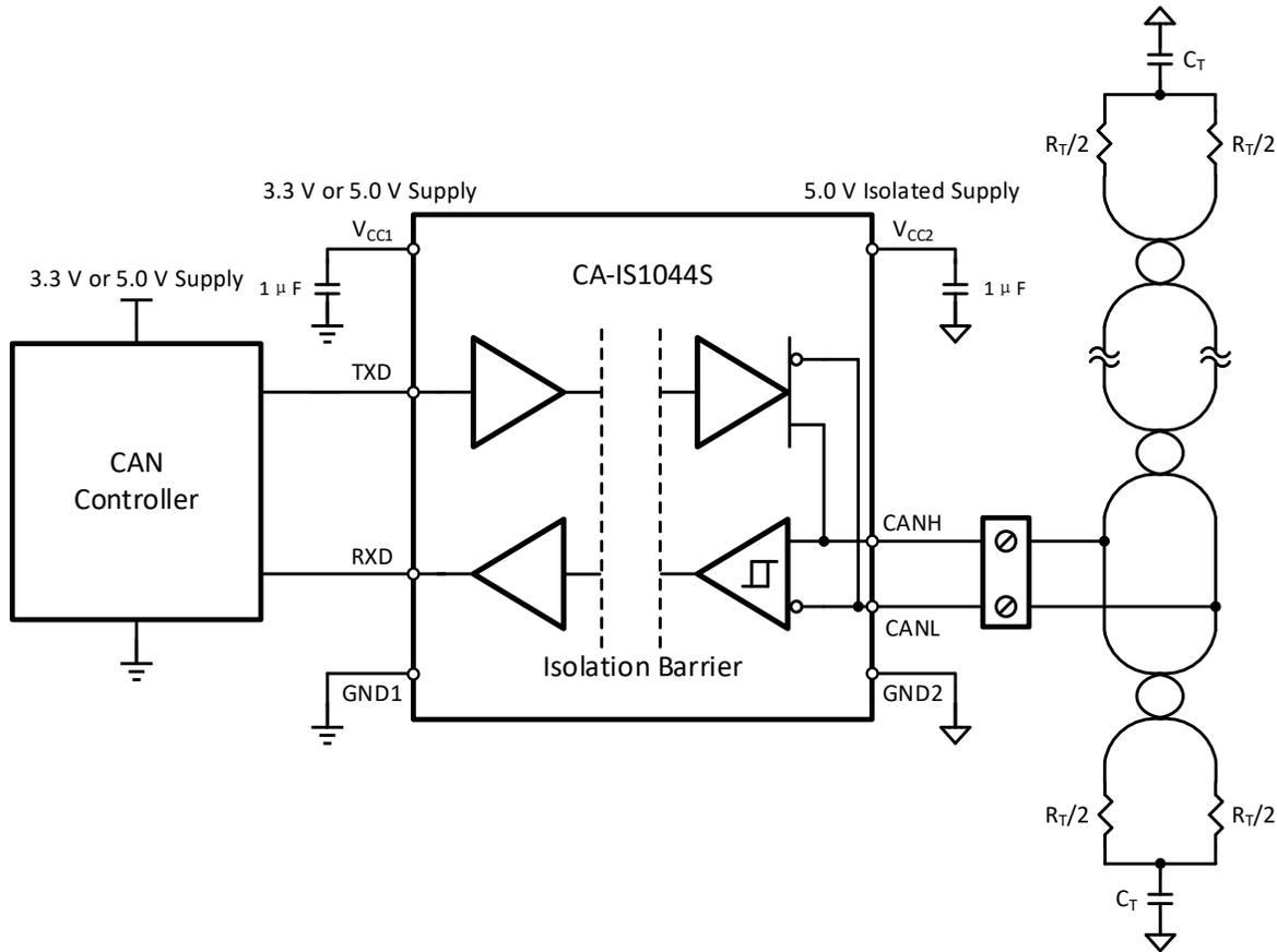
图 10-1 基于 CA-IS1044S 的典型隔离式 CAN 节点
