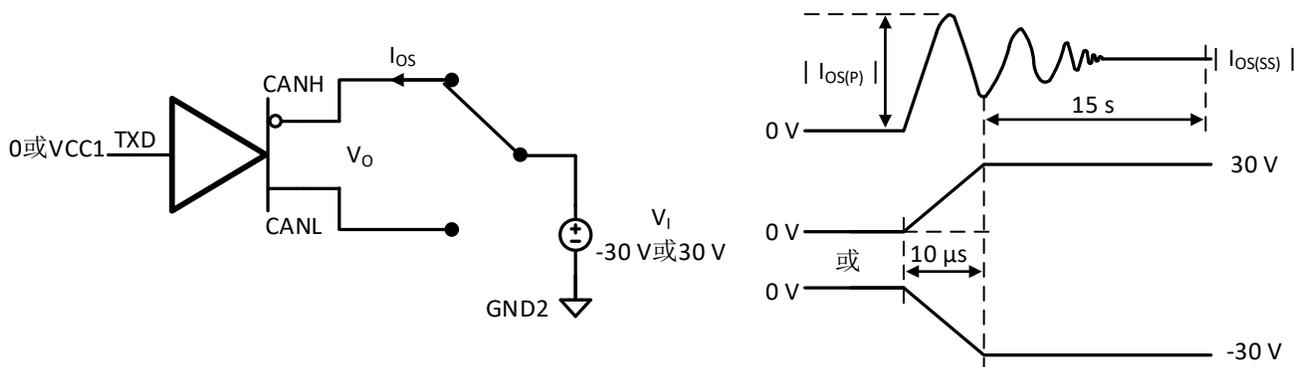
图 8-10 输出短路电流测量电路和波形
