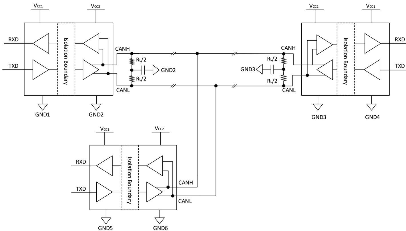
图 10-2 基于 CA-IS1044S 的典型 CAN 总线拓扑
