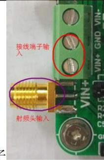
时，表示采用同相输入方式，此时信号从射频头或接线端子输入；拨开短
