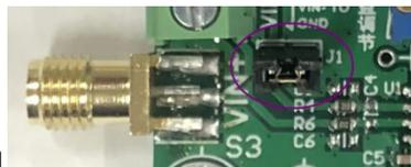
模块中的短路套 J1 用于输入方式选择，使用短路帽短接
