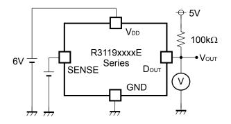
**Detector Threshold Test Circuit**
