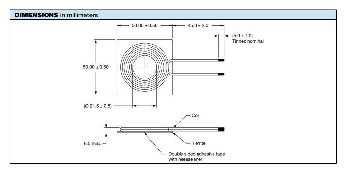
DESCRIPTION IWTX-5050FE-F1 10 µH 10 % EΒ e3 JEDEC<sup>®</sup> LEAD (Pb)-FREE MODEL INDUCTANCE INDUCTANCE PACKAGE CODE TOLERANCE STANDARD
