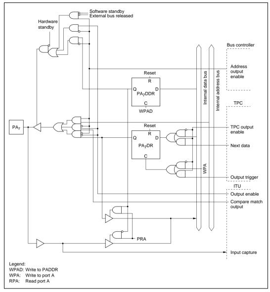
Figure C.10 (d) Port A Block Diagram (Pin PA<sub>7</sub>)
