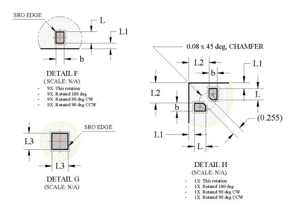
Figure 8.3. Package Edge Detail
