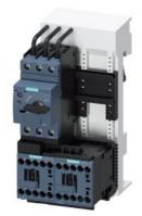
FUSELESS MOTOR STARTER REVERSING OPERATION 600V AC SZ S00 0.18-0.25A 220/240V AC 50/60HZ SCREW CONNECTION FOR SNAPPING ONTO 60 MM BUSBAR SYSTEMS TYPE OF COORDINATION 2 IQ = 150 KA ALSO FULFILLS TYPE OF COORDINATION 1 1NC (PER CONTACTOR)
