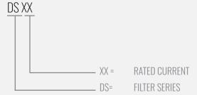
NOTE: USE ANY COMBINATION OF -X (AMPS) WITH ANY -Y RATINGS E.G. **DS100**(100 AMPS)
