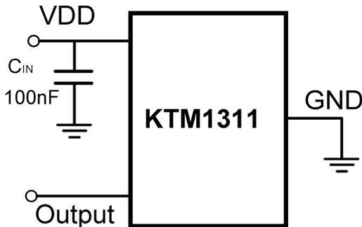
注: 为了滤除芯片电源端的噪声, 电源和地之间需连接一个100nF 电容, 且电容尽量接近VDD引脚。
