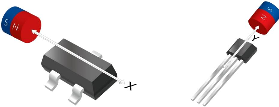
如下图，KTM1311可以检测平行于芯片封装表面的磁场。
