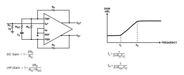
FIGURE 37. TRANSMIT EQUALIZER
