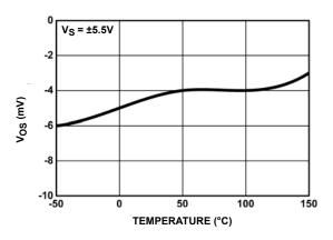
FIGURE 27. OFFSET VOLTAGE vs TEMPERATURE
