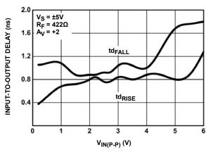
FIGURE 16. INPUT-TO-OUTPUT DELAY
