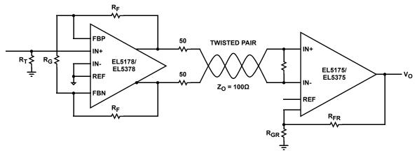
FIGURE 36. TWISTED PAIR CABLE RECEIVER
