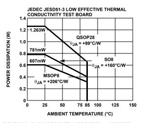
FIGURE 30. PACKAGE POWER DISSIPATION vs AMBIENT TEMPERATURE
