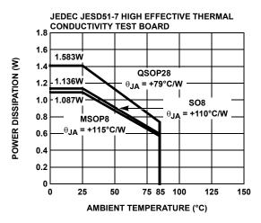
FIGURE 31. PACKAGE POWER DISSIPATION vs AMBIENT TEMPERATURE
