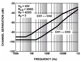
FIGURE 15. CHANNEL SEPARATION vs FREQUENCY
