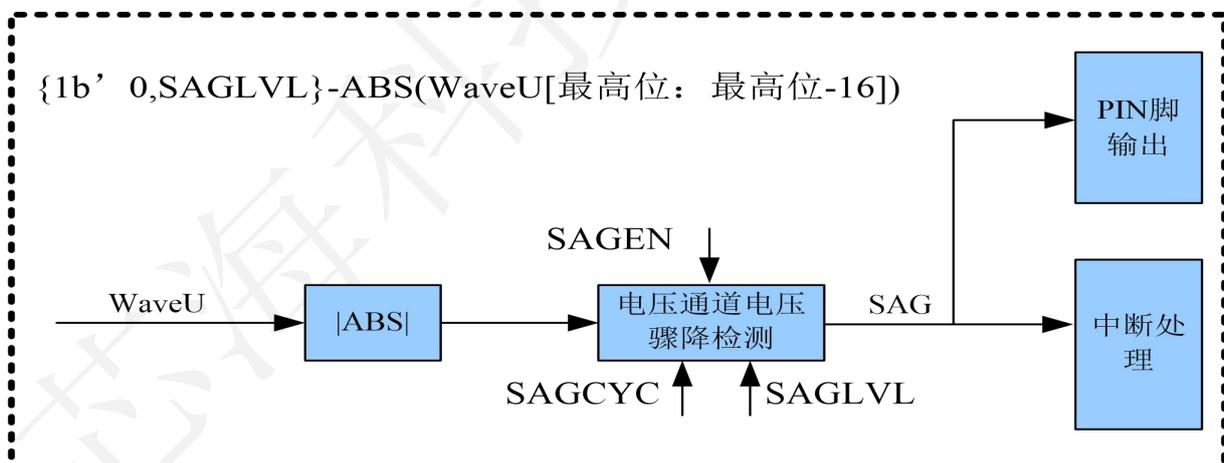
图 19 电压骤降检测示意图
