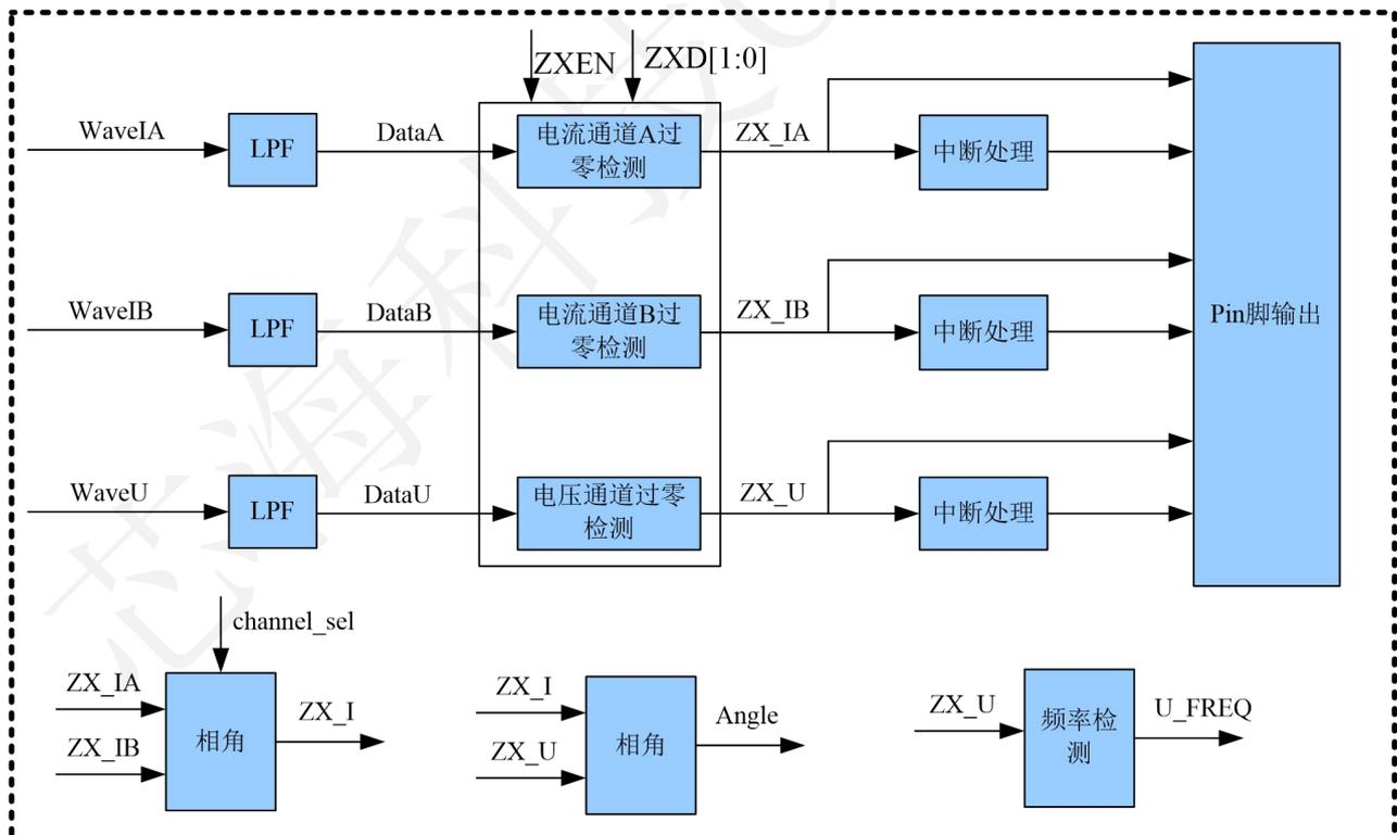
图 12 过零波形及过零中断示意图
