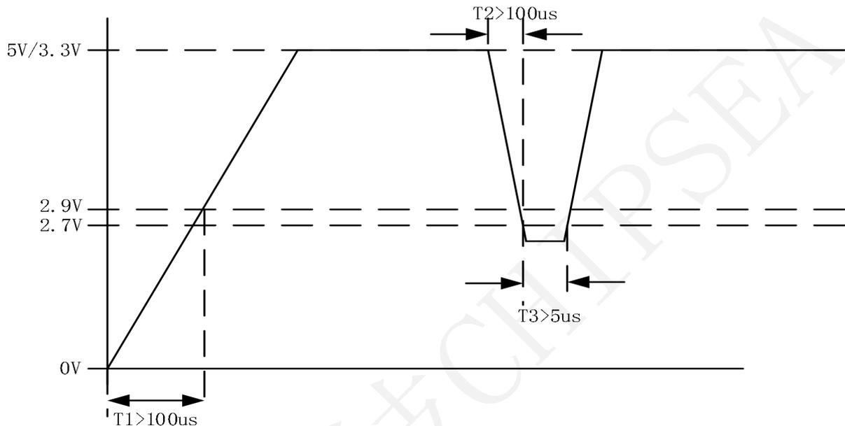
图 3 上电/掉电复位示意图
