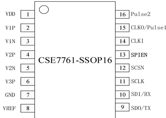
图 1 CSE7761-SSOP16 封装 PIN 脚图
