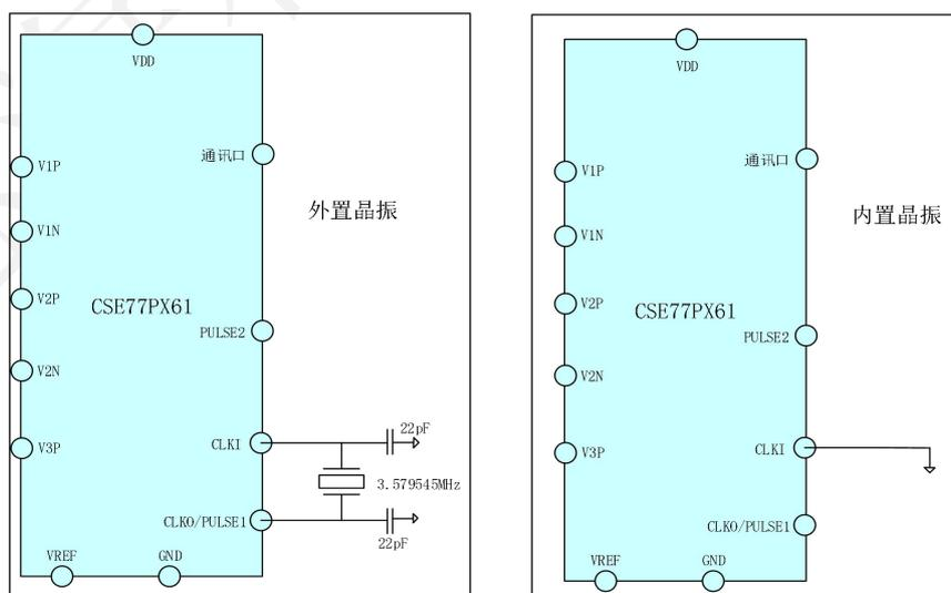
图 4 晶振选择示意图
