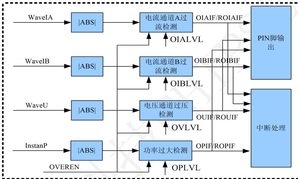
图 17 过压过流功率过载检测示意图
