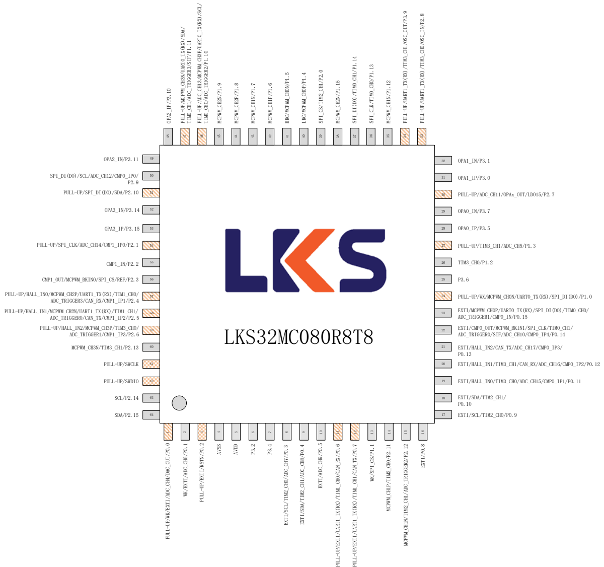
图 3-1 LKS32MC080R8T8(B)管脚分布图
