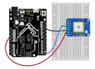
Board 5V or 3.3V to GPS module VIN.
