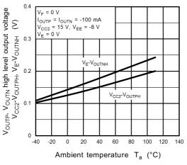
Fig. 13.3.15 V<sub>CC2</sub> - V<sub>OUTPH</sub>, V<sub>E</sub> - V<sub>OUTNH</sub> - T<sub>a</sub>
