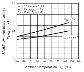
Fig. 13.3.26 V<sub>FAULTL</sub> - T<sub>a</sub>
