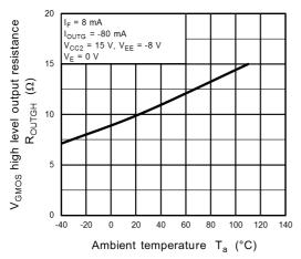
Fig. 13.3.17 R<sub>OUTGH</sub> - T<sub>a</sub>
