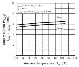
Fig. 13.3.19  $I_{CC2H}$ ,  $I_{CC2L}$  -  $T_a$
