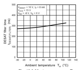
Fig. 13.3.35 t<sub>DESAT(LEB)</sub> - T<sub>a</sub>
