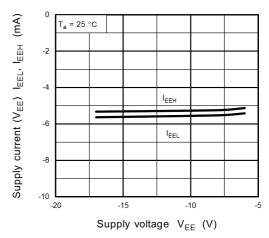
Fig. 13.3.22 I<sub>EEH</sub>, I<sub>EEL</sub> - V<sub>EE</sub>
