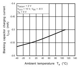
Fig. 13.3.23 I<sub>CHG</sub> - T<sub>a</sub>
