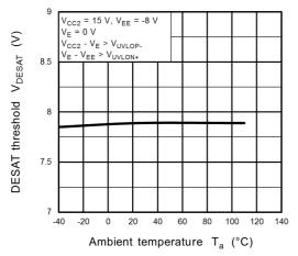
Fig. 13.3.25 V<sub>DESAT</sub> - T<sub>a</sub>
