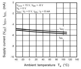
Fig. 13.3.20 I<sub>EEH</sub>, I<sub>EEL</sub> - T<sub>a</sub>
