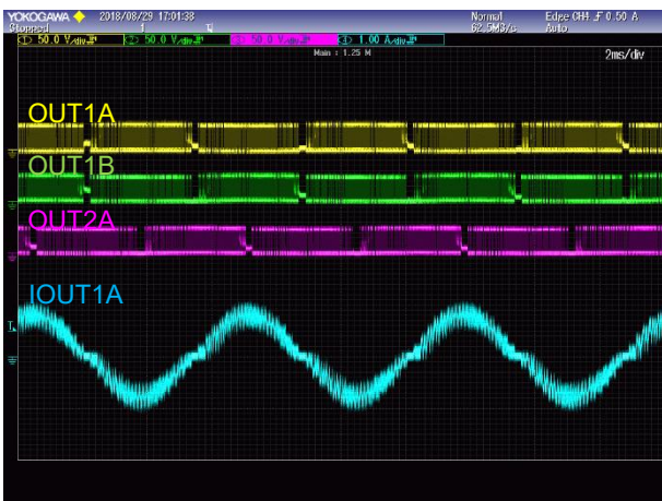
Figure 18. 1/8 STEP ( CLK : 4800Hz )
