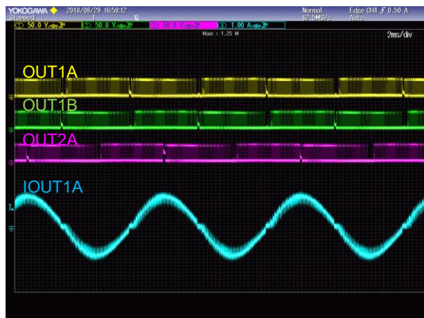
Figure 19. 1/16 STEP ( CLK : 9600Hz )
