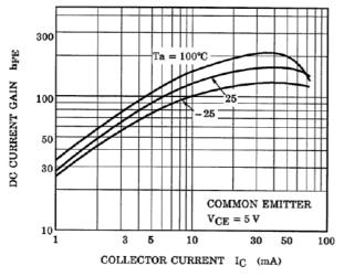
Fig. 10.15 RN1303 h<sub>FE</sub>-I<sub>C</sub>
