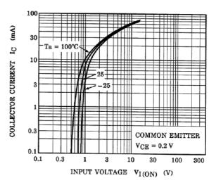
Fig. 10.6 RN1306 I<sub>C</sub>-V<sub>I(ON)</sub>
