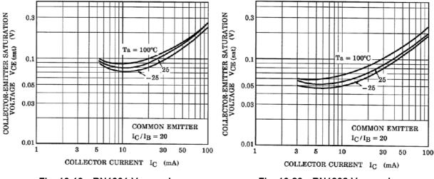
Fig. 10.19 RN1301 V<sub>CE(sat)</sub>-I<sub>C</sub>
