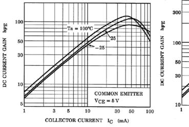
Fig. 10.13 RN1301 h<sub>FE</sub>-l<sub>C</sub>
