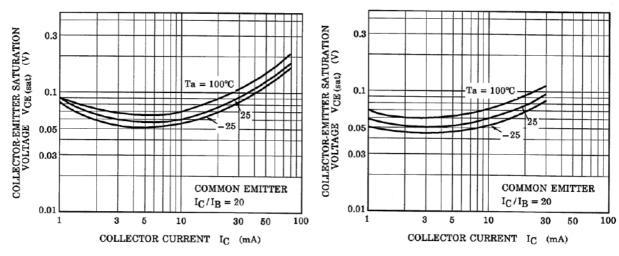
Fig. 10.21 RN1303 V<sub>CE(sat)</sub>-I<sub>C</sub>
