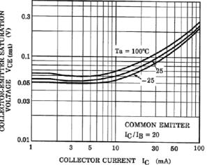
Fig. 10.24 RN1306 V<sub>CE(sat)</sub>-I<sub>C</sub>
