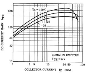
Fig. 10.16 RN1304 h<sub>FE</sub>-I<sub>C</sub>
