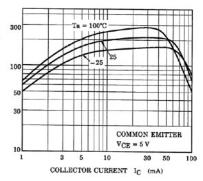
Fig. 10.18 RN1306 h<sub>FE</sub>-I<sub>C</sub>
