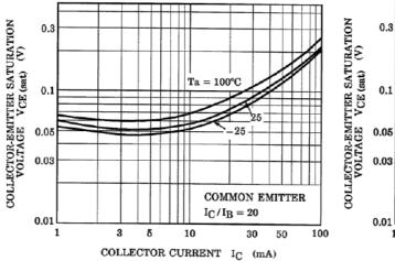
Fig. 10.23 RN1305 V<sub>CE(sat)</sub>-I<sub>C</sub>
