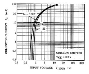
Fig. 10.5 RN1305 I<sub>C</sub>-V<sub>I(ON)</sub>
