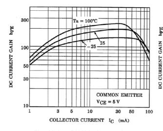
Fig. 10.17 RN1305 h<sub>FE(sat)</sub>-I<sub>C</sub>
