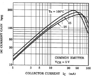
Fig. 10.14 RN1302 h<sub>FE</sub>-I<sub>C</sub>
