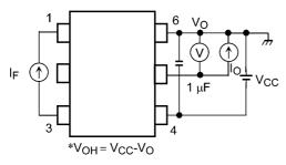
Fig. 13.1.3 V<sub>OH</sub> Test Circuit
