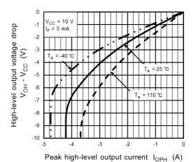
Fig. 13.2.10 (V<sub>OH</sub> - V<sub>CC</sub>) - I<sub>OPH</sub>
