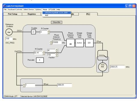
Figure 2-5. LMX2541SQ2060E Code Loader Settings
