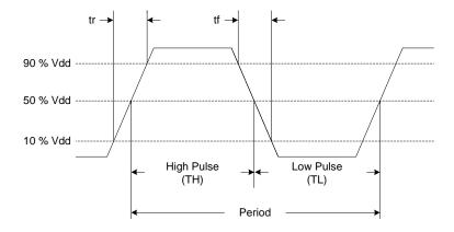
Figure 15. LVCMOS Waveform Diagram<sup>[14]</sup>
