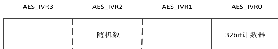
图 16-8 32 位计数器和随机数的存储方式
