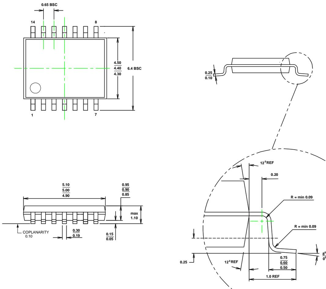
图46. TSSOP-14 封装尺寸图 (单位: 毫米)
