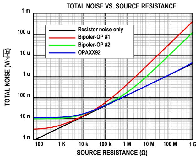
图34. 放大器与不同输出阻抗信号源连接的系统输入噪声图
