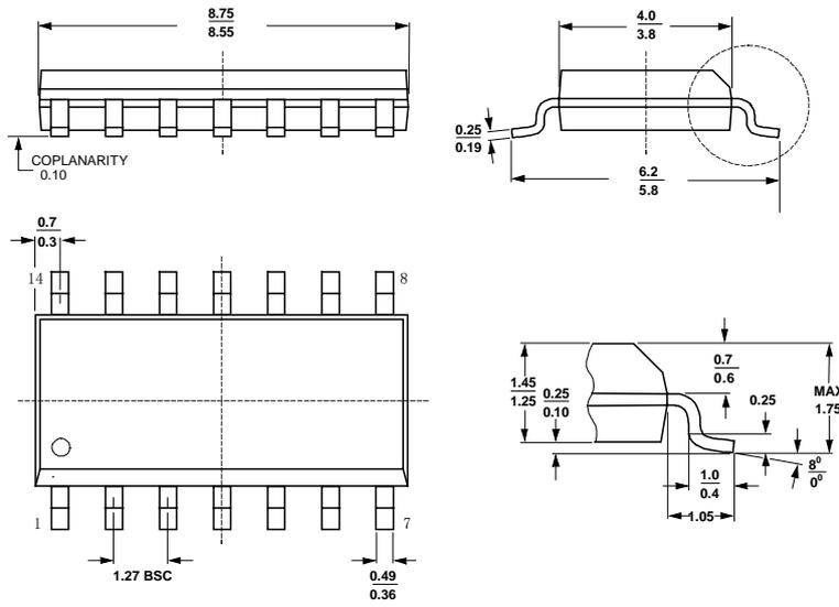
图45. SOIC-14 封装尺寸图 (单位: 毫米)
