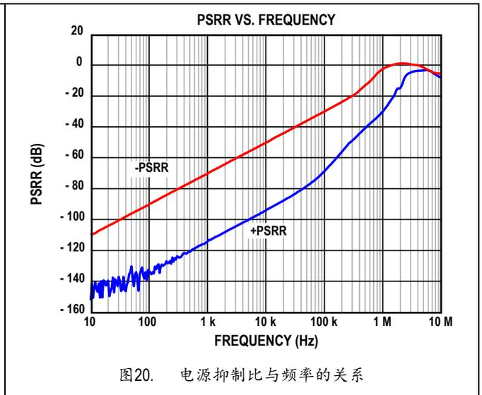
图20. 电源抑制比与频率的关系
