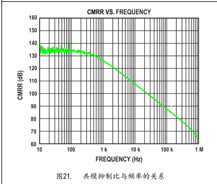
图21. 共模抑制比与频率的关系
