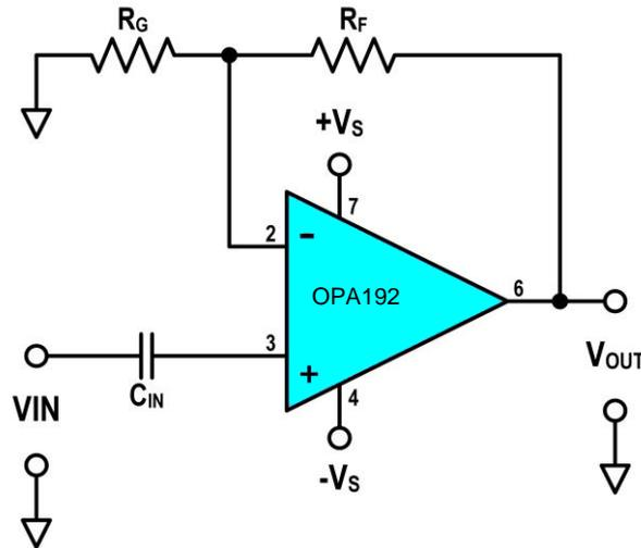
图36. 错误的交流耦合运算放大器电路
