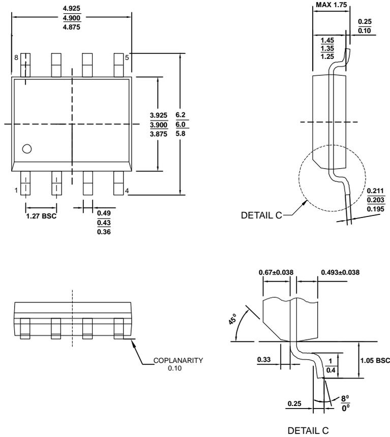
图43. SOIC-8 封装尺寸图 (单位: 毫米)
