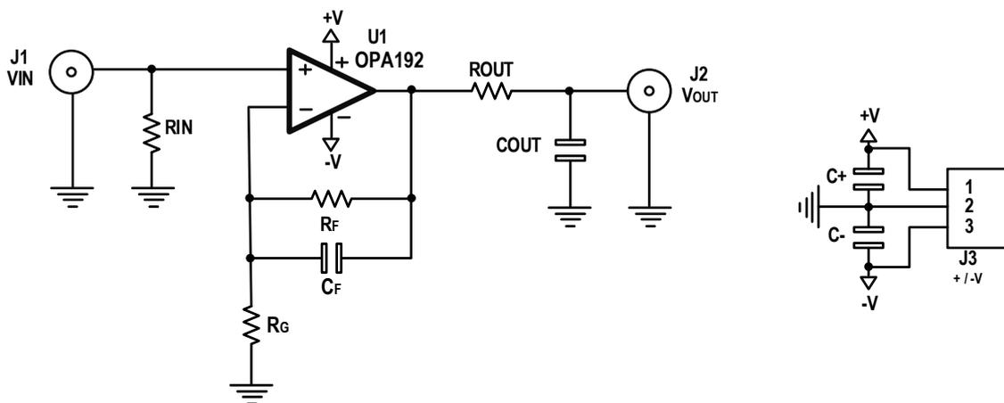
图39. 同相配置的运算放大器原理图
