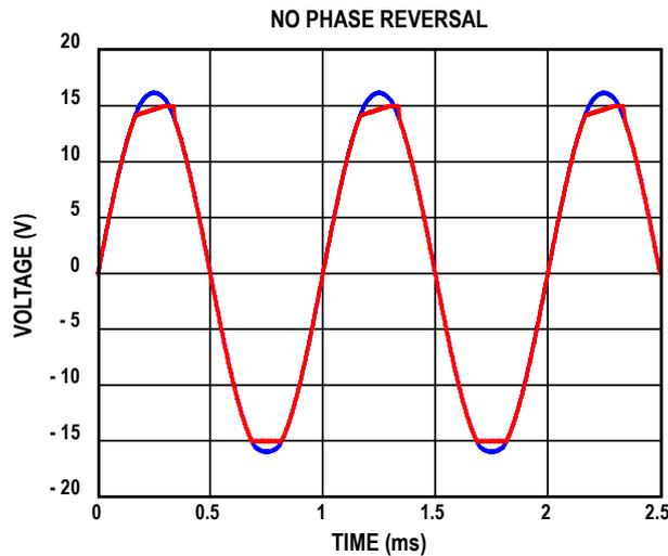
图35. OPA192 没有输出相位反转的现象
