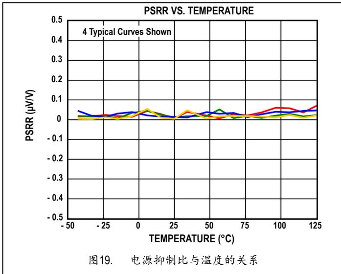
图19. 电源抑制比与温度的关系
