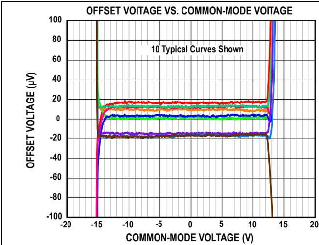
图7. 失调电压与输入共模电压的关系
