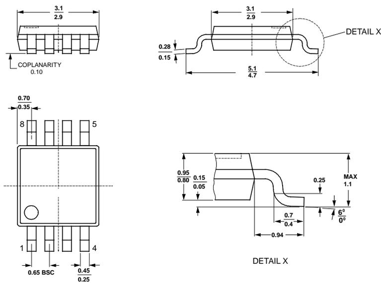
图44. MSOP-8 封装尺寸图 (单位: 毫米)
