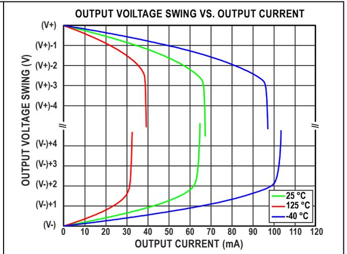
图32. 输出电压摆幅与输出电流的关系
