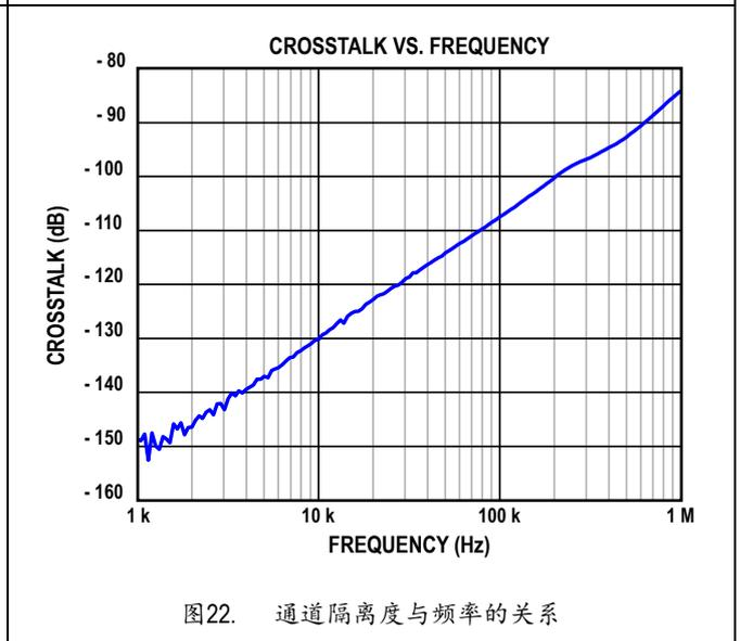
图22. 通道隔离度与频率的关系
