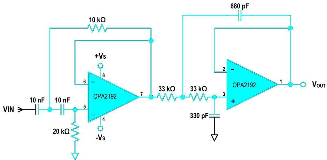
图38. 使用 OPA2192 实现 2 级带通 KRC 滤波器
