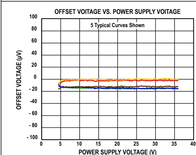
图11. 失调电压与电源电压的关系
