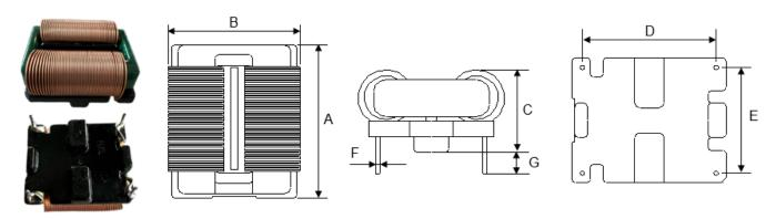
PCB aperture ≥ Ф 1.2mm
