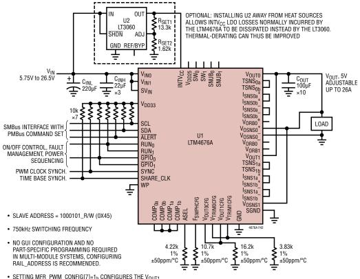
• SETTING MFR\_PWM\_CONFIG[7]=1 $_b$  CONFIGURES THE V<sub>OUT1</sub> CONTROL LOOP TO USE THE V<sub>OSNS0</sub> $^+$ /V<sub>OSNS0</sub> $^-$  DIFFERENTIAL-SENSE PIN-PAIR AS THE FEEDBACK SIGNAL FOR REGULATING V<sub>OUT1</sub>.
