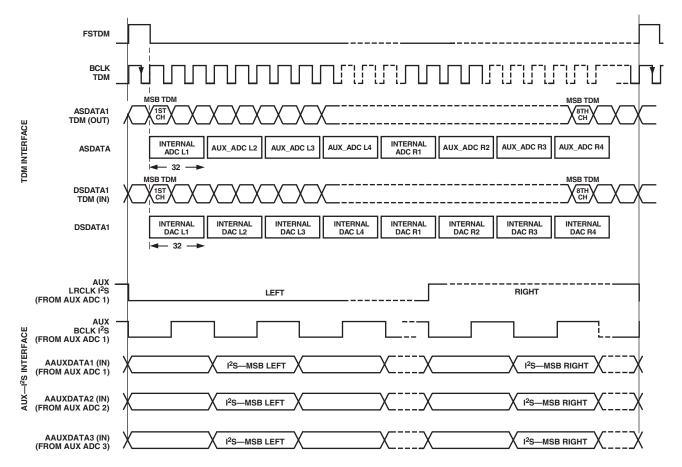
AUX BCLK FREQUENCY IS 64  $\times$  FRAME-RATE; TDM BCLK FREQUENCY IS 256  $\times$  FRAME-RATE.
