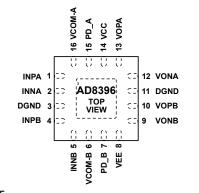
NOTE THE EXPOSED PAD IS NOT CONNECTED INTERNALLY. FOR INCREASED RELIABILITY OF THE SOLDER JOINTS AND MAXIMUM THERMAL CAPABILITY IT IS RECOMMENDED THAT THE PAD BE SOLDERED TO THE GROUND PLANE.
