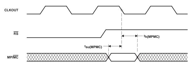
Figure 27. MP/MC Timing
