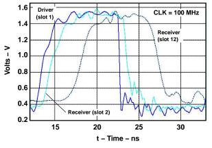
Figure 5. Source-Synchronous Clock
