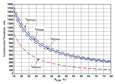
Figure 21. Current-Limit Threshold Vs.R<sub>ILIM</sub>
