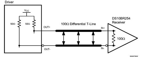
Typical CML Driver DC-Coupled Interface to an DS10BR254 Input
