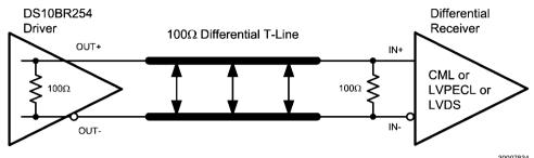
Typical DS10BR254 Output DC-Coupled Interface to an LVDS, CML or LVPECL Receiver
