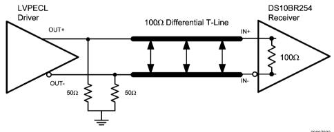
Typical LVPECL Driver DC-Coupled Interface to an DS10BR254 Input
