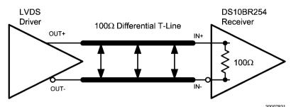
Typical LVDS Driver DC-Coupled Interface to an DS10BR254 Input
