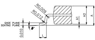
DIMENSIONS IN MILLIMETERS DIMENSIONS IN INCH SYMBOLS MIN MON MAX MIN MON MAX 1.75 1.95 2.16 0.069 0.077 0.085 0.05 0.15 0.25 Α1 0.002 0.006 0.010 1.70 1.80 0.071 A2 1.91 0.067 0.075 0.35 0.42 0.48 0.014 0.017 0.019 b C 0.19 0.20 0.25 0.007 0.008 0.010 D 5.18 5.28 5.38 0.204 0.208 0.212 D1 5.13 5.23 5.33 0.202 0.206 0.210 Ε 5.18 5.28 5.38 0.204 0.208 0.212 E1 5.13 5.23 5.33 0.202 0.206 0.210 1.27 0.050 е Н 7.70 7.90 8.10 0.303 0.311 0.319 0.50 0.65 0.80 0.020 0.026 L 0.031 0.10 0.004 у
