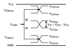
Figure 9. V<sub>CMR</sub> Diagram
