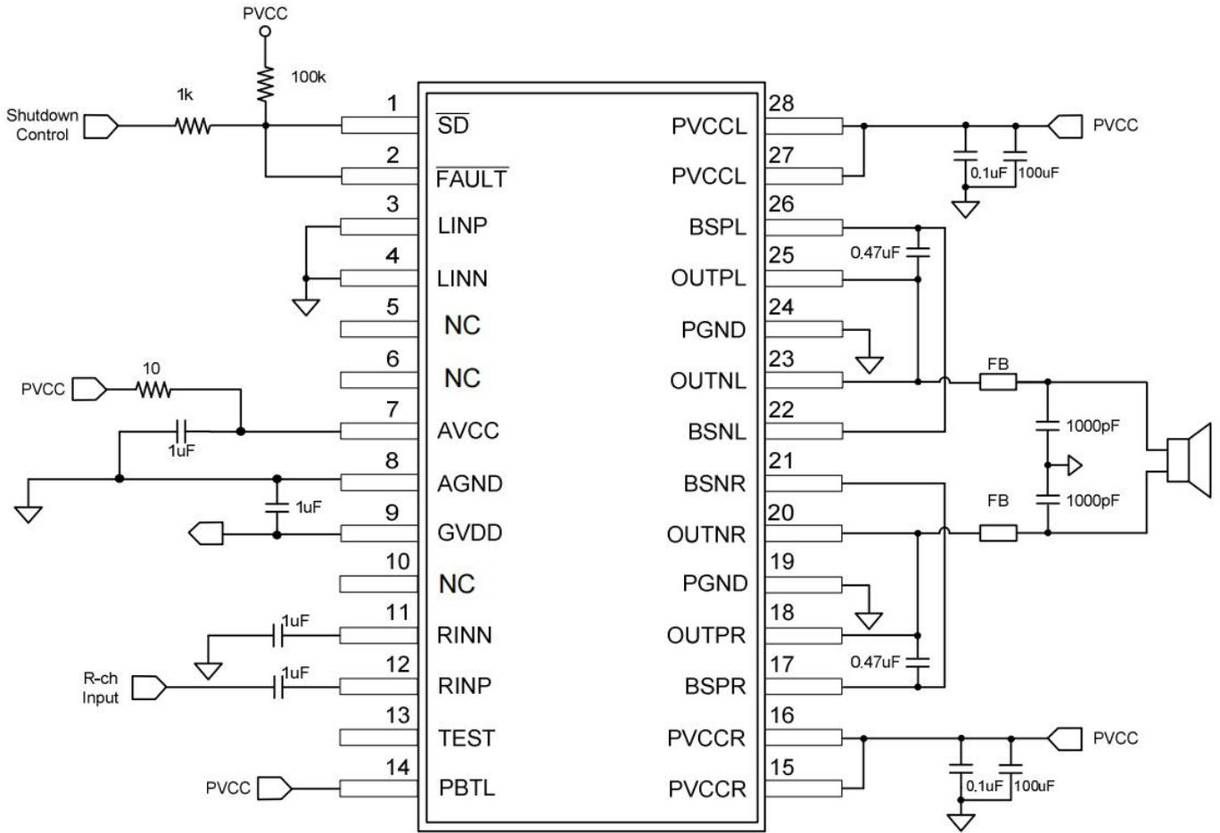
单端输入，PBTL 输出的 D 类放大器
