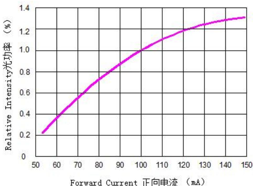
**ELECTRICAL CHARACTERISTICS 电特性( $T_j=25^\circ\text{C}$ )—UVC**
