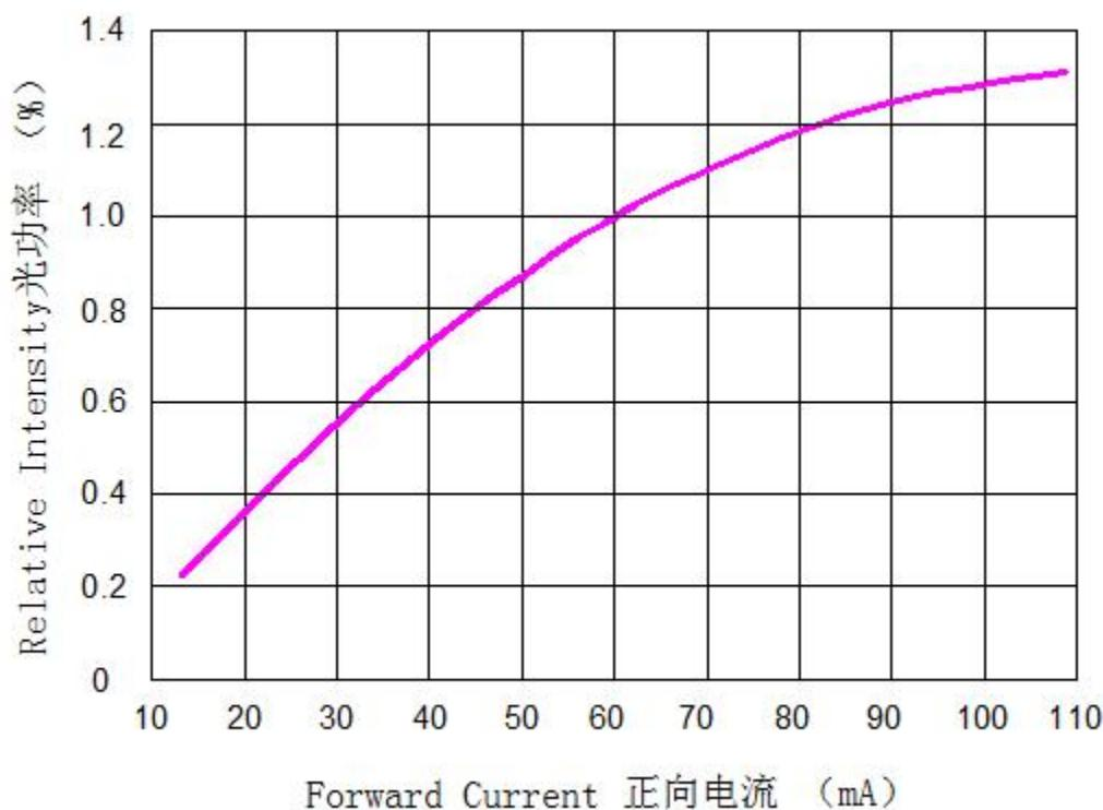
**ELECTRICAL CHARACTERISTICS 电特性(T<sub>j</sub>=25°C)---UVA**
