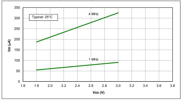
FIGURE 32-5: IDD MAXIMUM, EC OSCILLATOR, MEDIUM-POWER MODE
