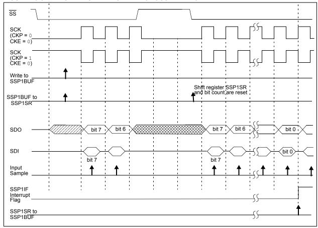
FIGURE 25-9: SPI MODE WAVEFORM (SLAVE MODE WITH CKE = 0)
