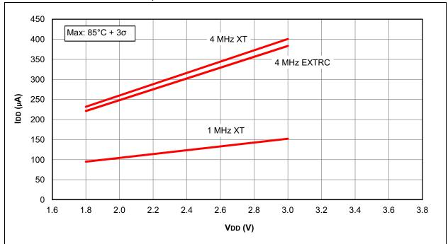
FIGURE 32-4: IDD TYPICAL, EC OSCILLATOR, MEDIUM-POWER MODE
