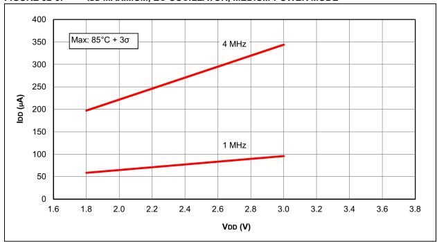
FIGURE 32-6: IDD TYPICAL, EC OSCILLATOR, MEDIUM-POWER MODE
