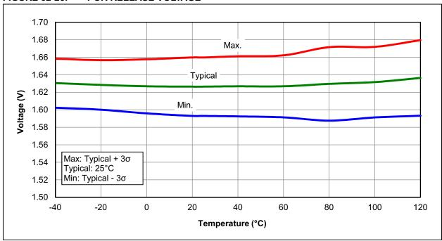
FIGURE 32-27: POR REARM VOLTAGE
