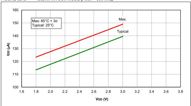
FIGURE 32-9: IDD TYPICAL, HFINTOSC MODE
