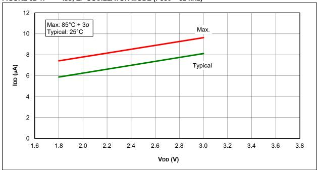
FIGURE 32-2: IDD TYPICAL, XT AND EXTRC OSCILLATOR
