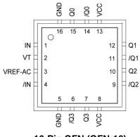
16-Pin QFN (QFN-16)
