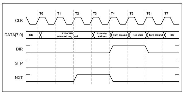
FIGURE 6-6: ULPI EXTENDED REGISTER READ IN SYNCHRONOUS MODE
