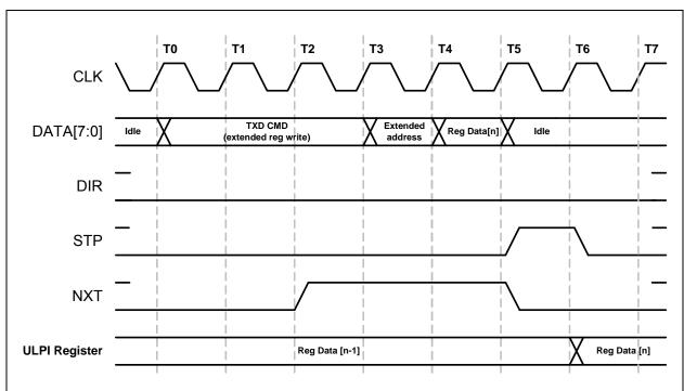
FIGURE 6-4: ULPI EXTENDED REGISTER WRITE IN SYNCHRONOUS MODE
