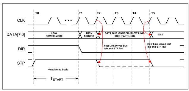
FIGURE 6-10: EXITING LOW POWER MODE
