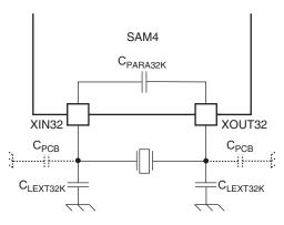
$C_{LEXT32K} = 2 \times (C_{CRYSTAL} - C_{PARA32K} - C_{PCB} / 2)$
