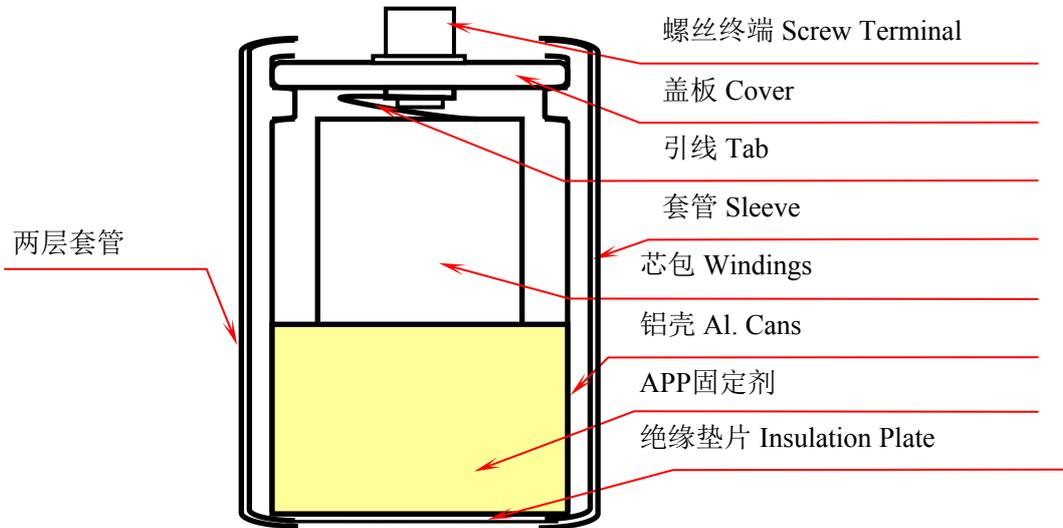
6-2 工艺芯包分解图 (Element drawing)
