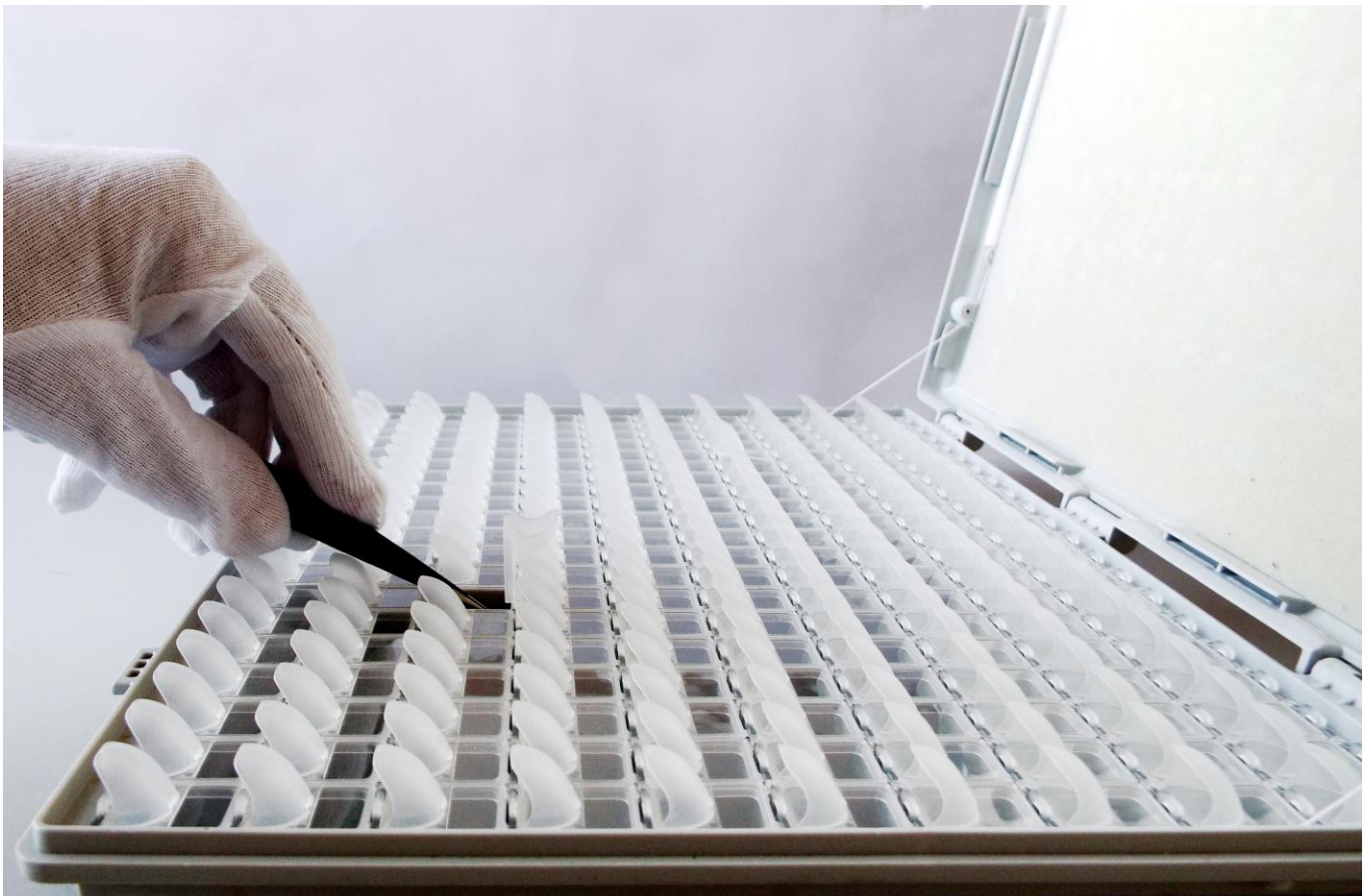
图 14. 单手操作存储或夹取贴片元件
