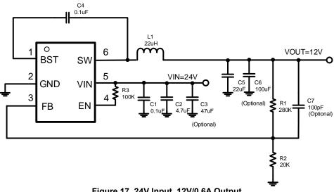
Figure 17. 24V Input, 12V/0.6A Output
