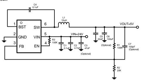
Figure 16. 24V Input, 5V/0.6A Output
