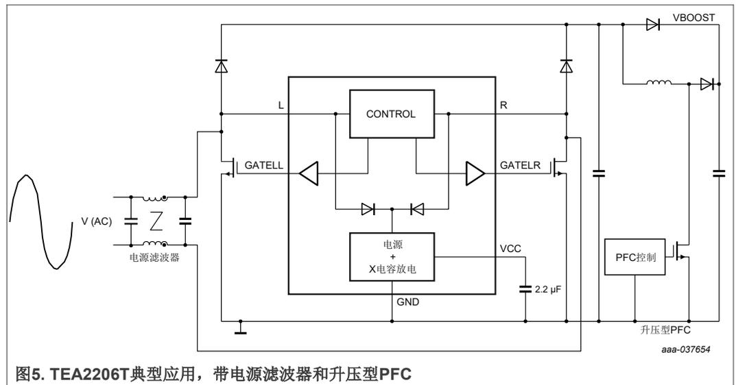
图5. TEA2206T典型应用，带电源滤波器和升压型PFC
